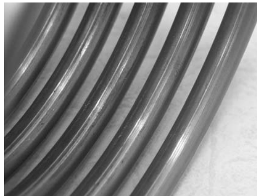
圖四十七 彈簧內側的表面刮傷
