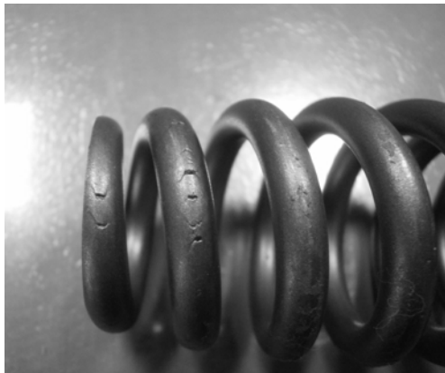
圖四十四 捲製彈簧表面龜裂
