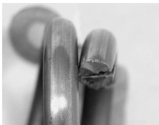
圖五十五 二次剪切造成龜裂
